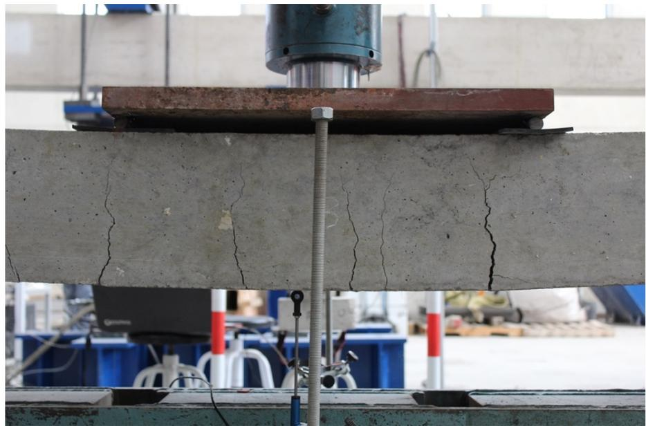
Foto 3: Ensayo a rotura
