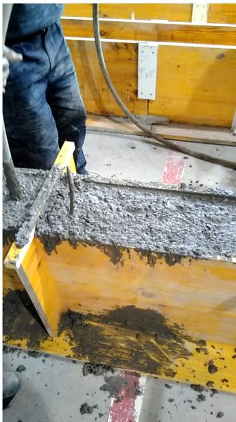
Foto 2: Fabricación de probeta
